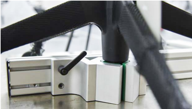
Prisma für Prüfobjektfixierung | Test numunesini sabitleme için prizma
