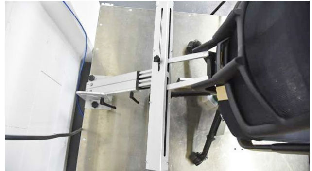
Ausrichtungszangen für Objektausrichtung | Numune hizalama için direkler
